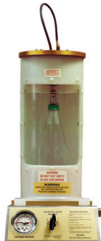
Secure-Seal-Tester zur Messung von Dichtigkeit und Druckentlastung
